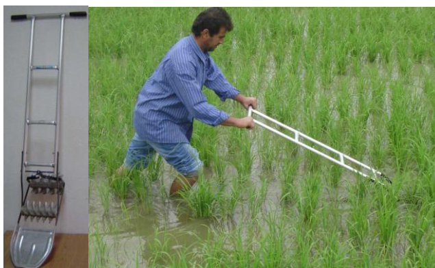
شکل ۴- نحوه کار با دستگاه وجین‌کن مکانیکی نوع دستی
