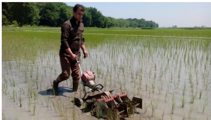
شکل ۷- طرز کار با وجین کن نوع دستی موتوردار
